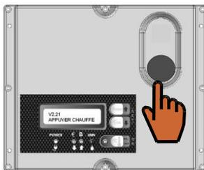
Die Taste zur Pumpensteuerung drücken und dann die Teile mit der in den Bürstenhalter eingesetzten Bürste reinigen.
