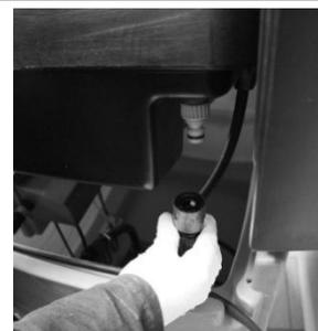
11. Replacer le filtre inox, la bonde à index (les index doivent être positionnés, pliures vers le haut), et la tôle inox avec la vague
