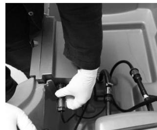
**3** Raccorder le connecteur de la pompe sur le kit.
