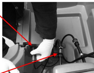
9. Placer le câble du kit électrique dans la rainure prévue à cet effet
