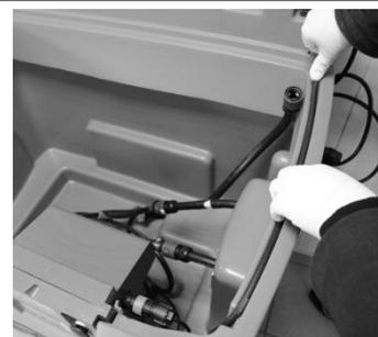
10. Remettre l'évier en place. Au préalable, reclipser le tuyau noir sous l'évier et replacer le tuyau du pinceau dans son échancrure.
